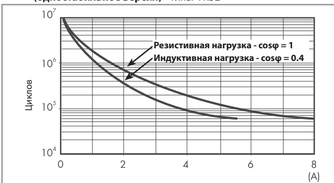
F 41 - Электрическая долговечность (АС) при ном. нагрузке (одностабильное версия) - Типы 41.52
