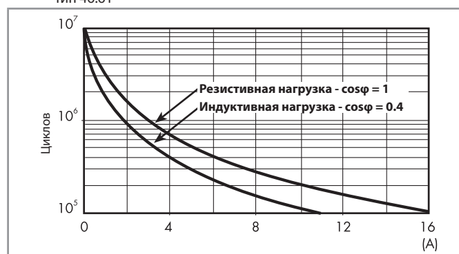
F 46 - Электрическая долговечность (AC) при ном. нагрузке Тип 46.61
