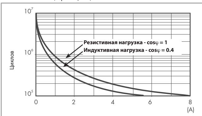
F 40.4 - Электрическая долговечность (АС) при ном. нагрузке Тип 40.52 (страница 30)
