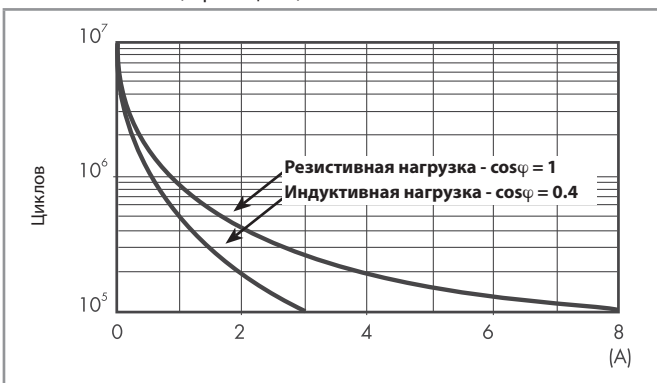
F 40.4 - Электрическая долговечность (АС) при ном. нагрузке Тип 40.52 (страница 30)
