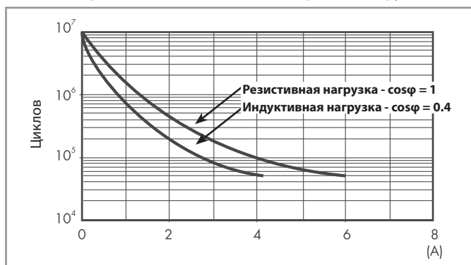
F 32 - Электрическая долговечность (AC) при ном. нагрузке
