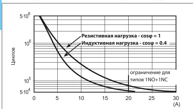
F 65 - Электрическая долговечность (AC) при ном. нагрузке
